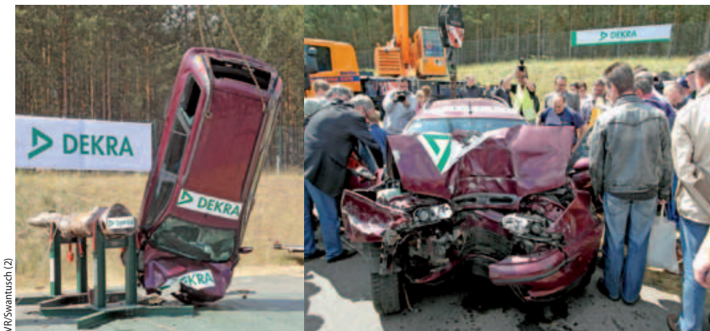
Fall aus großer Höhe: Der PKW trifft mit gut 50 km/h auf den längsliegenden Baum auf
